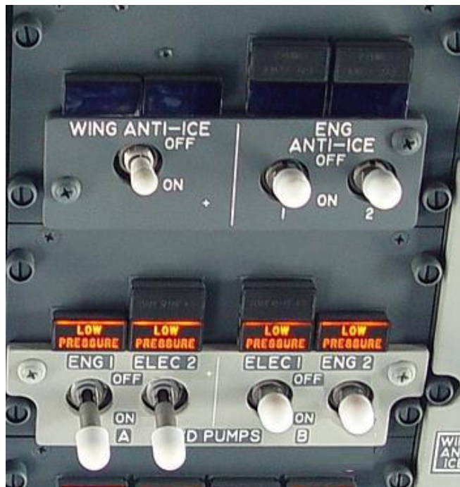
Тумблеры насосов гидросистемы могут быть перепутаны с тумблерами обогрева двигателя
